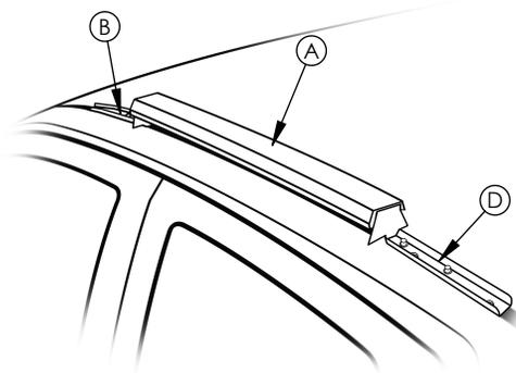
4 - Fixar os suportes "B", "C", "D" e "E" com os parafusos "K", conforme imagens abaixo.
