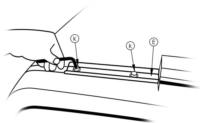
5 - Encaixar as capas "F", "G", "H" e "I" e fixá-las nos Rebites com rosca interna dos suportes "B", "C", "D" e "E" com os parafusos "L", em seguida encaixar os tampões "M" nos furos, finalizando assim a instalação.
