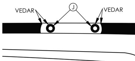
3 - Posicionar os suportes "B", "C", "D" e "E" que seguem montados nas longarinas "A", por cima das borrachas "J" que foram centralizadas na furação do veículo.
