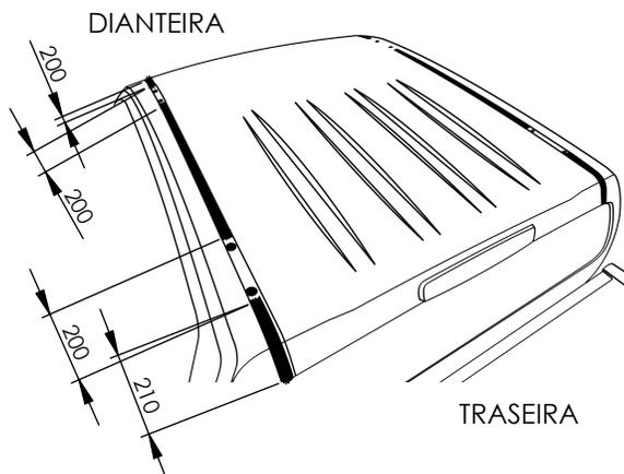
2 - Posicionar as Borrachas "J" nas esperas com rosca M8 existentes na canetela do veículo e vedar com massa de calafetar ou silicone as posições onde foi cortado o friso do carro e nas borrachas "J".
